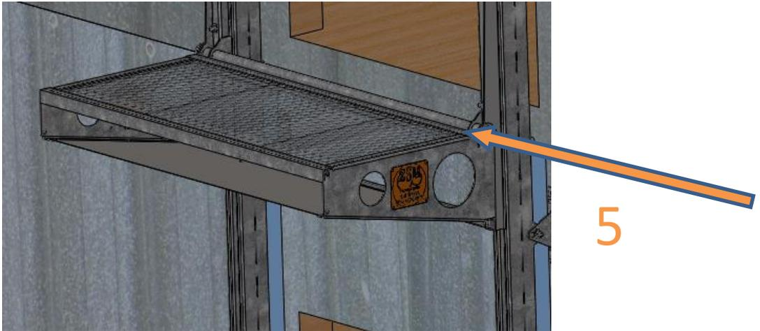
5/ Poser la passerelle en insérant l'axe pivot par le coté. Mettre une goupille fendue au bout de l'axe pour l'empêcher de sortir de la passerelle.
