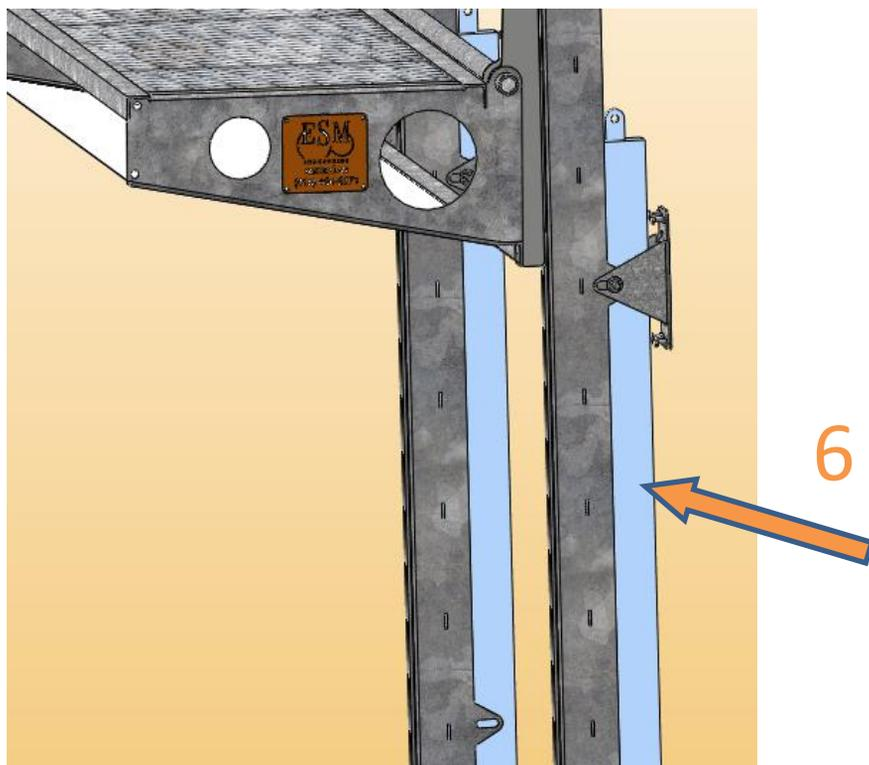
6/ Poser les contre-poids dans les rails. Fixer les cables et s'assurer que les cables passent sur les poulies. Faire coulisser la passerelle de haut en bas, ajuster le rail non-fixé au besoin et ensuite serrer final. Sceller au silicone.
