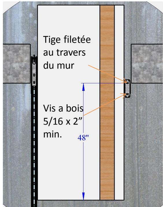
1/ Poser les 2 ancrages du haut. La rainure du haut à 48" du seuil de porte de 3è. Percer le mur et installer un tige filetée 5/16NC-18 au travers du mur, avec une plaque d'appui d'au moins 2" de diametre à l'intérieur du bâtiment.
