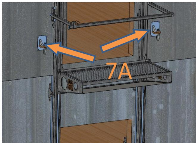
7A/ Poser les plaques pour harnais approx. 4 pieds au dessus de la passerelle ajustée en position basse. Il doit y avoir au moins une tige filetée qui traverse le mur et une contre-plaque pour chacune des 2 plaques. Sceller au silicone.
