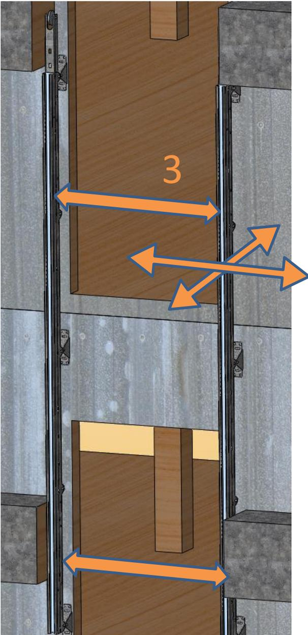
3/ Mettre un rail de niveau sur tous les cotés et fixer final. Sceller au silicone. Mettre le second rail de niveau et à égale distance sur la longueur par rapport au premier rail. Ne pas fixer le second rail final.
